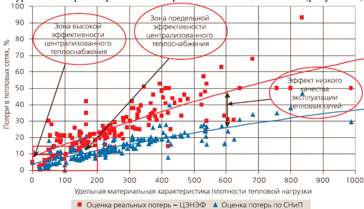
Рисунок 2.2. Зависимость потерь в тепловых сетях от удельной материальной характеристики тепловых сетей
